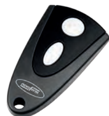
Mini-Novotron 502 2-Kanal, 433 MHz, KeeLoq-Wechselcode
