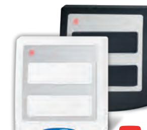
Funk-Innentaster Signal 111 2-Kanal, 433 MHz, KeeLoq- Wechselcode zur Steuerung von 2 Antrieben oder 1 Antrieb und 1 Außenbeleuchtung, aus UV-beständigem Material, wahlweise in weiß oder schwarz
